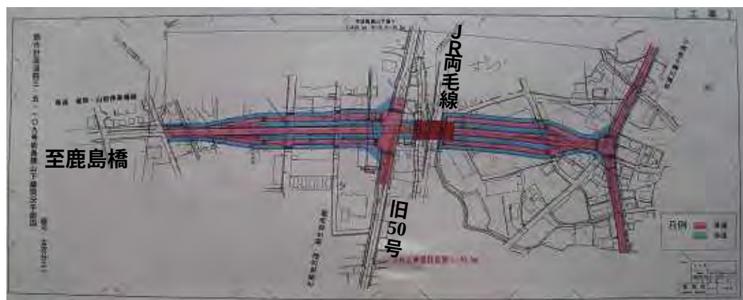
旧50号線とJR両毛線をアンダーパス化する計画図
